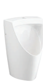
C31717 รุ่น สีนโว โถปัสสาวะชาย แขวนผนัง (น้ำเข้าด้านบน) 340 x 325 x 520 mm. ใช้กับฟลัชวาล์วระยะ 45 mm.
