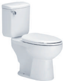
C1302 Dimension Sydney 45/ ซิดนีย์ 45 390 x 790 x 840 mm. Type / Shape Two Piece toilet สุกภัณฑ์สองชิ้น / Elongate อีลองเกต Pipe S-trap 305 mm. Water system Siphonjet 6 Liters
