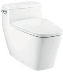
C101907 Dimension Hercules Curve / เฮอร์คิวลีสเคิร์ฟ 450 x 745 x 600 mm. Type / Shape One Piece toilet สุกภัณฑ์ชิ้นเดียว / Rectangle ทรงเหลี่ยม Pipe S-trap 305 mm. Water system V-Silent 4.8 Liters
