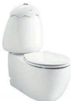
C15027 WH Googai II / กูกิโก๊ II Dimension 365 x 640 x 720 mm. Type / Shape กูกิโก๊ II สุกกิ้นทึ่สองชิ้น (ทึ่ออกผผนัง) / Googai II two piece toilet (P-Trap) Pipe P-Trap, rough-in 180 mm. Water system Triplex Flush 3/4.5 Liters
