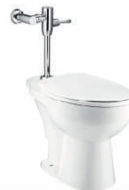
C13021 Dimension Sydney 45/ ซิดนีย์ 45 370 x 705 x 430 mm. Type / Shape Flush valve toilet สุกภัณฑ์ฟลัชวาล์ว / Elongate อีลองเกต Pipe S-trap 250 mm. Water system Siphonjet
