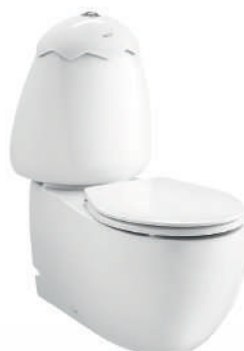
C15037 WH Googai II / กูกิโก๊ II Dimension 365 x 640 x 720 mm. Type / Shape Two Piece toilet สุกกิ้นทึ่สองชิ้น (ทึ่ลองพึ้น) / Round bowl ราวดีโบลึ่ด Pipe S-Trap 305 mm Water system Triplex Flush 3/4.5 Liters
