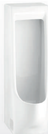
C31207BI Hercules / เฮอร์คิวลีส 325 x 415 x 1000 mm. Floor Stand ตั้งพื้น P-Trap, Rough-in 200 mm. Back inlet
