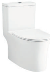
C105607 Dimension Vista / วิสต้า 400 x 710 x 755 mm. Type / Shape One Piece toilet สุกภัณฑ์ชิ้นเดียว / Rectangle ทรงเหลี่ยม Pipe S-trap 305 mm. Water system Siphonjet 4.8 Liters
