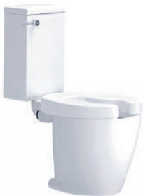
SC6652 Dimension Forall / ฟอรัล (ผ่าสี่ขาว) 420 x 740 x 925 mm. Type / Shape Two Piece toilet สุกภัณฑ์สองชิ้น / Elongate อีลองเกต Pipe S-trap 305 mm. Water system Wash down 3.8 Liters
